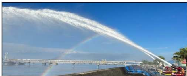
大容量泡放射システム放水訓練
